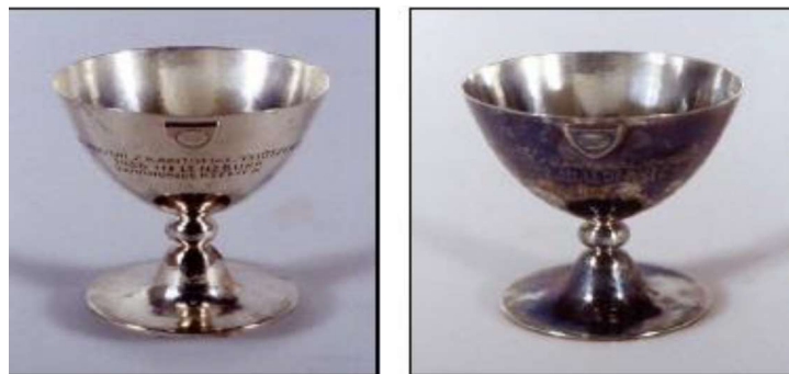
شکل ۲ تصاویری از جام نقره‌ای قبل و بعد از استفاده از پلاسما هیدروژن به مدت دو ساعت و نیم [۱۶].
