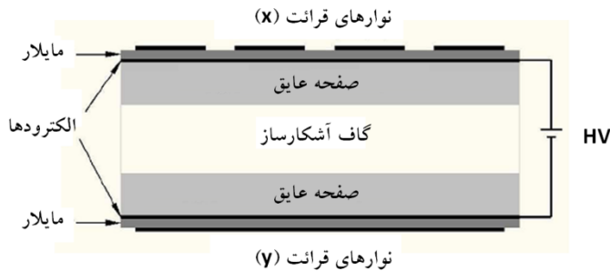
شکل ۱ ساختار یک آشکارساز صفحه عایق تک‌گافه.
