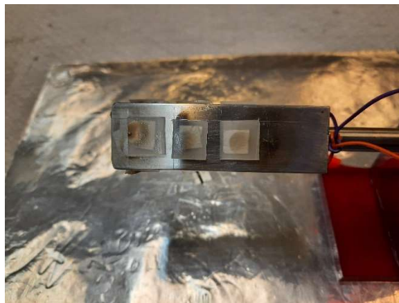
شکل ۴ نمونه‌های پلی اتیلن بر روی یک وجه نگهدارنده‌ی متحرک بعد از کاشت یون.
