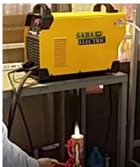
شکل ۷ شعله پلاسمايي مشعل و منبع تغذیه.
