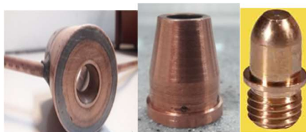
شکل ۴ از راست، (الف) کاتد مسی با سر تنگستنی هواخنک برای پیش‌یونش (behjoosh.com)، (ب) الکتروود میانی (نازل شناور مسی) هواخنک، طراحی جدید و (ج) سمت چپ آند مسی با خنک‌سازی آبگرد، طراحی جدید.
