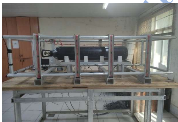
شکل ۷ نمایی از شبیه‌ساز میدان مغناطیسی ساخته شده به همراه مخزن فولادی درون آن.
