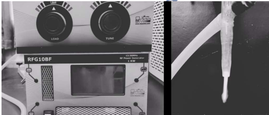
شکل ۱ تصویر ساختار جت پلاسمای فشار اتمسفری و پلاسمای تولید شده.
