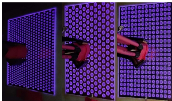
Figure 1 SDBD Plasma Devices شکل ۱ دستگاه‌های پلاسمای تخلیه سد دی‌الکتریک سطحی.
