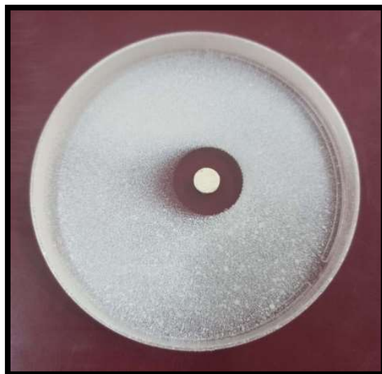
Fig. 13 Antibacterial test of silver by bacteria Coliform شکل ۱۳. تست آنتی باکتریال نقره توسط باکتری کلیفرم.
