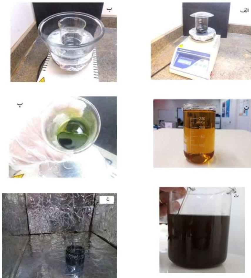
شکل ۱ (الف) محلول گرافیت و اسید سولفوریک در حال مخلوط شدن، (ب) محلول گرافیت و اسید در حمام آب و یخ، (پ) رنگ سبز تیره‌ی محلول پس از افزودن پرمنگات پتاسیم به محلول اسید و گرافیت، (ت) اکسید گرافین سنتز شده، (ث) تخلیه قوس الکتریکی الکترود نقره در محلول اکسید گرافین و (ج) تابش فرابنفش به نمونه‌ها.
