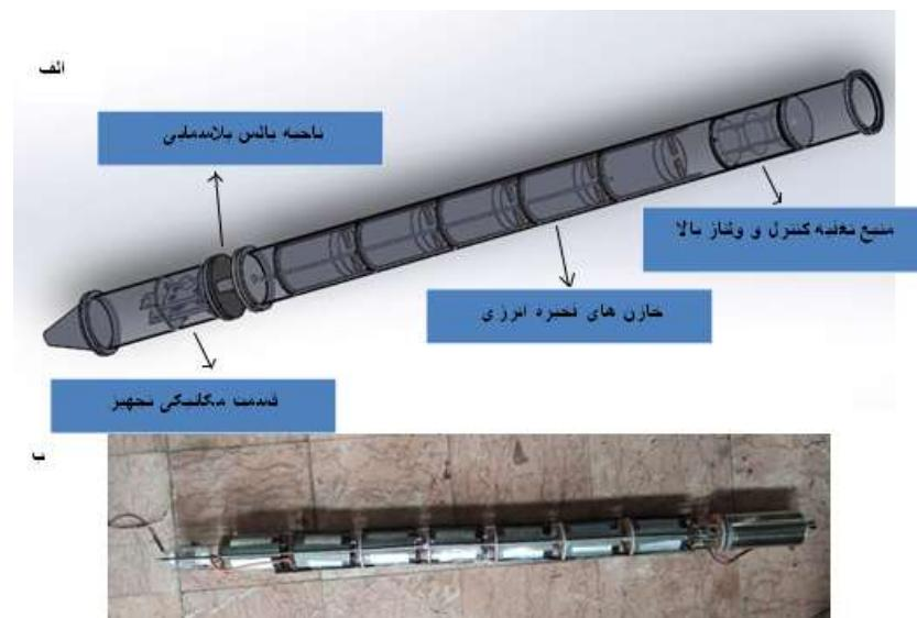
شکل ۲ (الف) شماتیک اجزای طراح شده در روش پالس پلاسمایی (ب) مجموعه خازن‌ها و قطعات قرار گرفته در داخل تجهیز پالس پلاسمایی.
