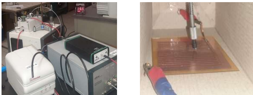
شکل ۶ چیدمان آزمایشگاهی اندازه‌گیری‌های طیف‌سنجی سامانه SDBD ساخته شده.
